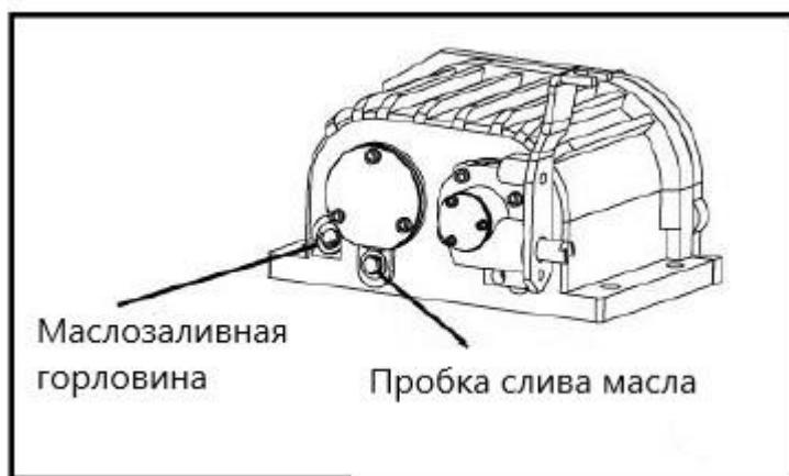
3. При замене масла в вибраторе выверните сливную пробку (рис. выше) и просто опрокиньте машину, чтобы слить масло. Обратите внимание, что масло легче слить, пока оно горячее.
